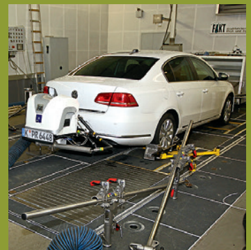
▲ Dit is PEMS: een Portable Emissions Measurement System – oftewel een draagbaar meetstation.
