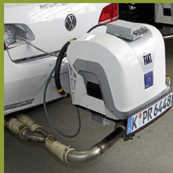
▲ Dit is PEMS: een Portable Emissions Measurement System – oftewel een draagbaar meetstation.
